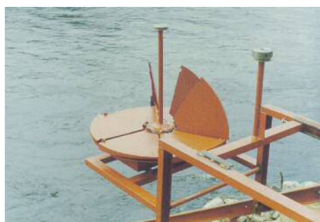
Levo: mala SP1 turbina prečnika 0,9 m na podiznoj rampi.
