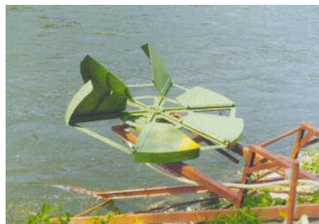
Levo: mala SP1 turbina prečnika 0,9 m na podiznoj rampi.
