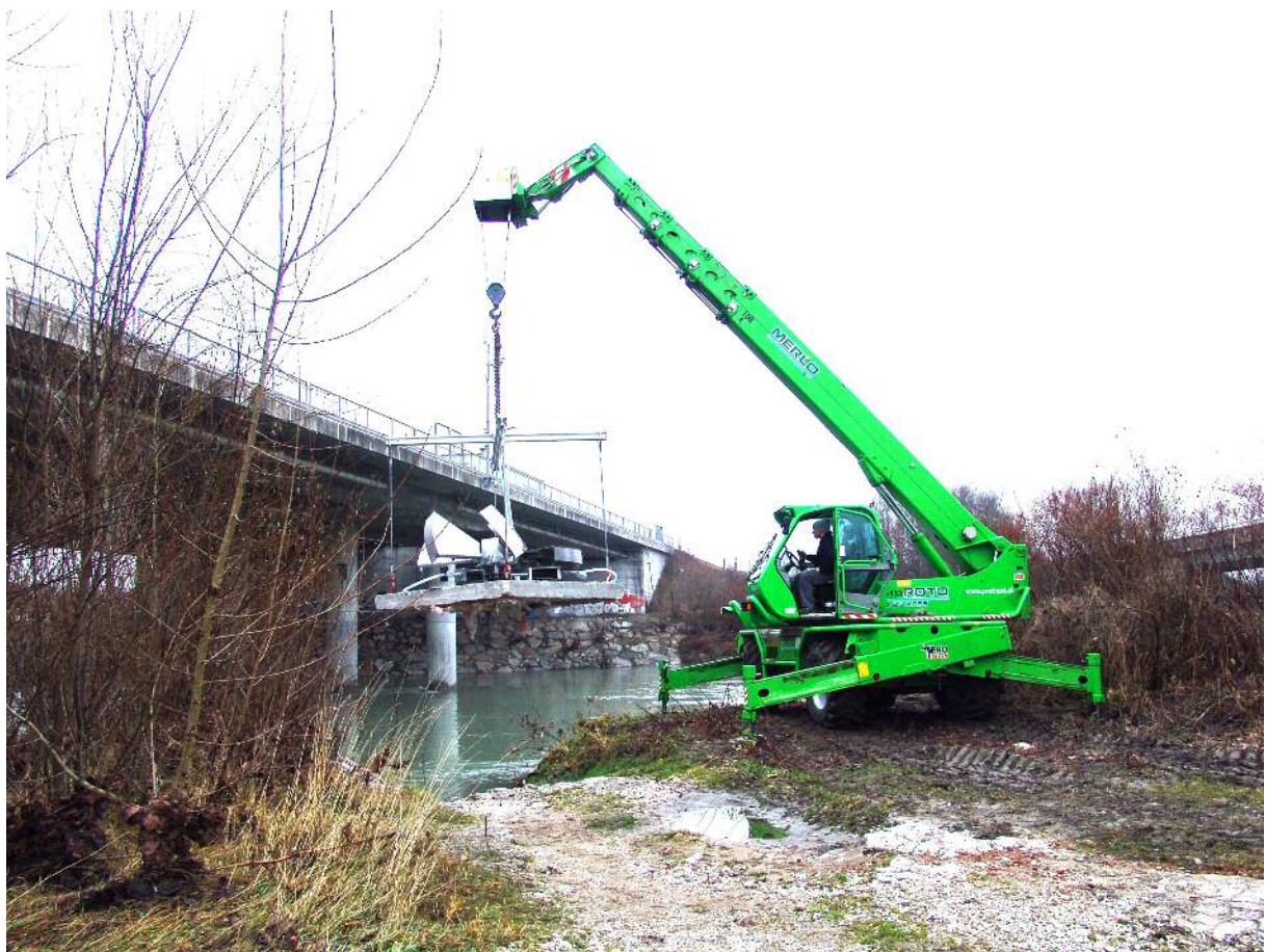
Fotografija iz leta 2009: Spuščanje manjše naprave SP1 na dno vodotoka reke Save v bližini Ljubljane.
