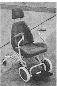
Novi voziček accord z vzdovnim pogonom handmaster II (premer prvih koles pri varianti na fotografiji je 28 cm).
