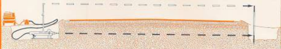
Slika 3: Pravilno nastavljena vrtna smer. Ob prihodu v luknjo na drugi strani ceste bo raketa zadela dno trasimo palice!
