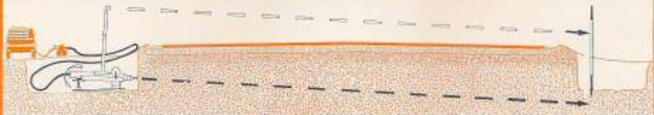
Slika 2: Napačno nastavljena smer vrtnja. S sukanjem nastavitvenih ročic, določimo zahtevano smer ter naklon bodočega preboja.
