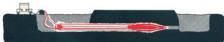
3. PO PILOTSKEM VRTANJU DELO PONOVI MO Z RAKETO POLOŽENO V RAZŠIRJEVALNO OHIŠJE Ø300 mm
