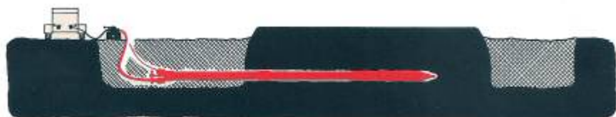
2. VRTANJE Z ISTOČASNIM VLEČENJEM PLASTIČNIH ALI KOVINSKIH CEVI
