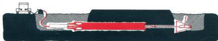
4. PO PILOTSKEM VRTANJU POTISKAMO JEKLENE CEVI DO Ø 500 mm
